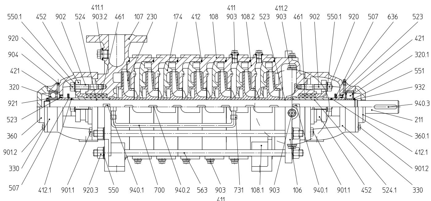
**Ausführung mit Stopfbuchspackung / Version with stuffing box packing**
