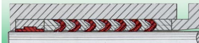
FIGURA 8 - Vedação típica com anéis em "V" com bucha dianteira de restrição. Typical plunger sealing with "V" frontal restriction bushing.
