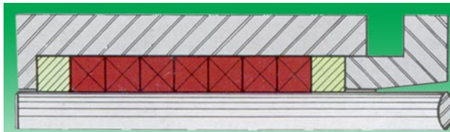
FIGURA 6 - Vedação por anéis de gaxeta com lubrificação pelo próprio líquido Plunger sealing with gasket rings lubricated by process liquid.
